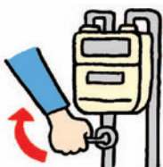
ガスメーターバルブ
