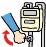
ガスメーターバルブ
